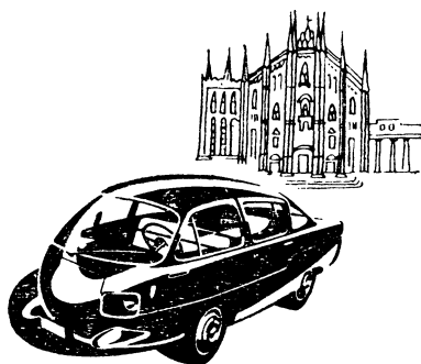
Обтекаемый «Морелли» сделан на базе агрегатов автомобилей «Фиат» (1957).
